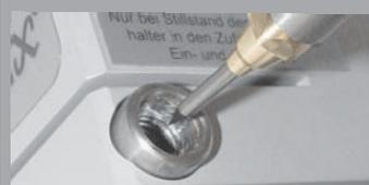
**Mit der eingestellten Tiefenlehre (optimale Abschliff-länge der Elektroden)** wird ein Abschleifen der Wolframelektrode von nur 0,3 mm erreicht. Sie ermöglicht damit einen geringen Elektrodenverbrauch, kürzeste Schleifzeit, geringe Staubentwicklung und schont die Diamantscheibe. Ein Entgraten der Wolframelektrode (>  $\varnothing$  1,6 mm) für das Aluminiumschweißen ist ebenfalls mit der Einstell-Lehre möglich.
