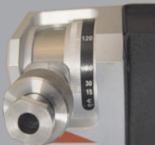
**An der Gradskala** kann der gewünschte Spitzwinkel stufenlos eingestellt werden. Schleifwinkel von 7,5° bis 90° ergeben einen Spitzwinkel von 15° bis 180°.
