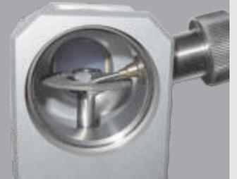
**Die integrierte Absaugung** und der auswechselbare Staubfilter sind eine weitere Besonderheit des Gerätes. Sie wurden an die Forderungen des Arbeits- und Gesundheitsschutzes angepasst.
