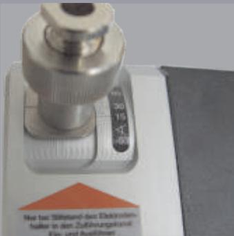
**Die Exzentrerscheibe** ermöglicht die 3-fache Ausnutzung der Diamantscheibe auf verschiedenen Schleifebenen und ist eine konstruktive Besonderheit des Schleifgerätes.
